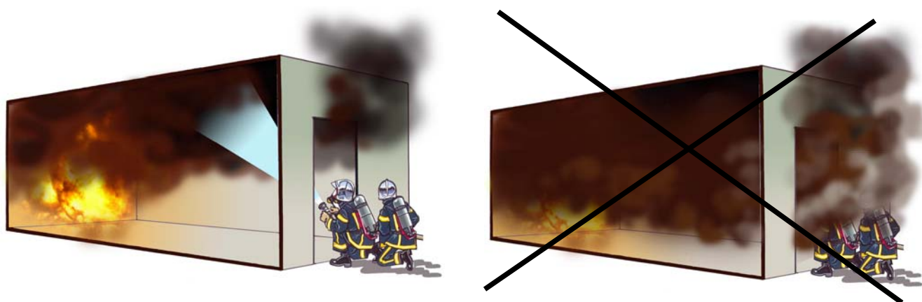
Maintien de la stratification de la couche de fumées
